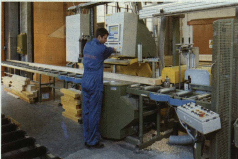
Slika 1: Izdelava montažnih elementov - žaganje elementov okvira
