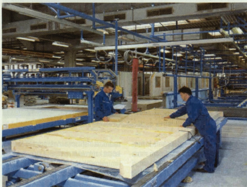
Slika 2: Vstavljanje toplotne izolacije v steno
