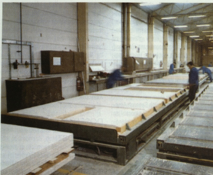
Slika 3: Izdelava stenskih elementov na delovnih mizah
